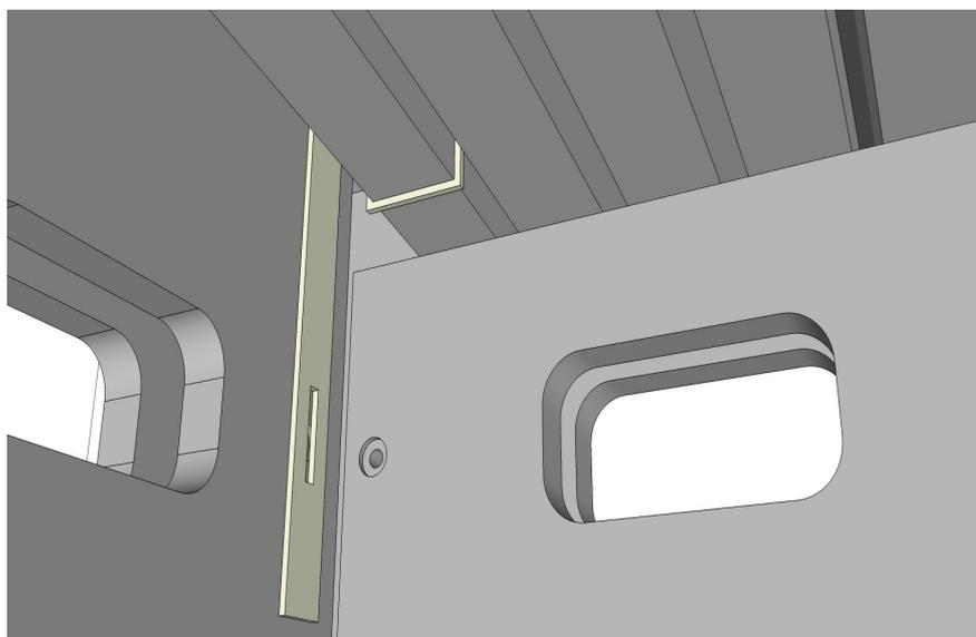
Particolare ancoraggio copertura. Le lame in ferro vengono posizionate sopra i travetti e fissate ai bulloni delle pendenze.
