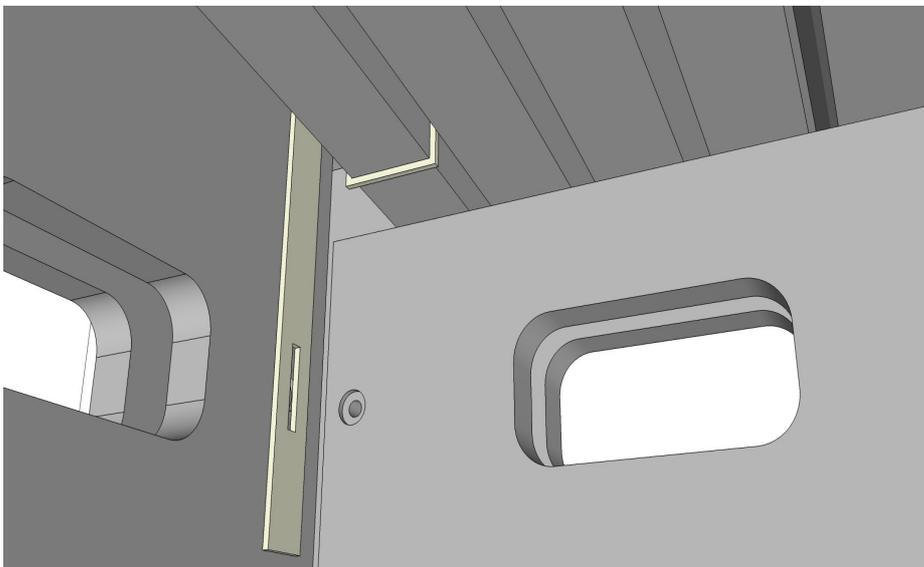
Particolare ancoraggio copertura. Le lame in ferro vengono posizionate sopra i travetti e fissate ai bulloni delle pendenze.
